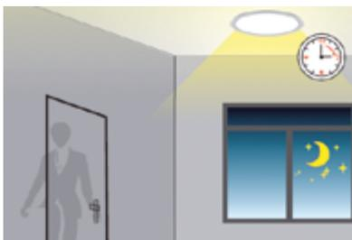
3 Nach Haltezeit, wird das Licht schrittweise auf ein geringeres Lichtlevel heruntergedimmt, solange keine weitere Bewegung erkannt wird.
